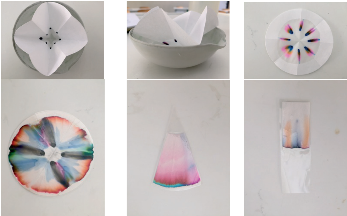
Arbeitsschritte und Versuchsergebnisse der Papierchromatografie
